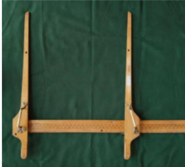
Abbildung 616: Holzmesskluppe klappbar, Patent Otten.
