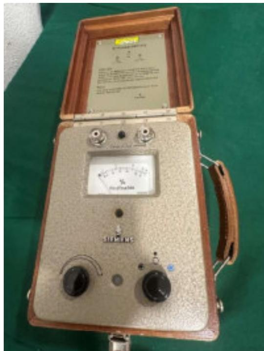
Abbildung 286: Siemens Holzfeuchtemessgerät.
