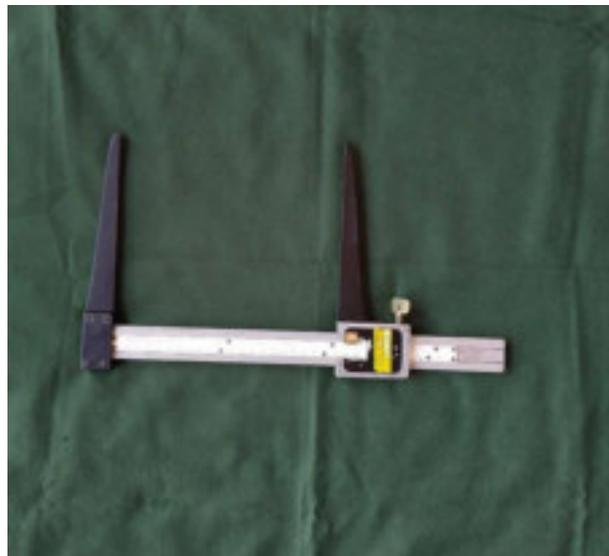
Abbildung 628: Holzmesskluppe aus Aluminium.
