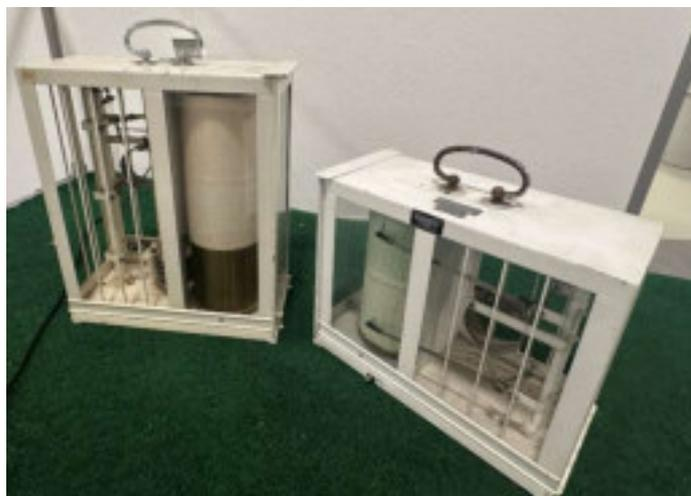
*Abbildung 225: Luftdruckmessgerät (Barometer).*
