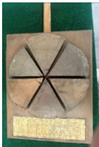
*Abbildung 477: Schautafel Schwinden und Quellen von Holz.*
