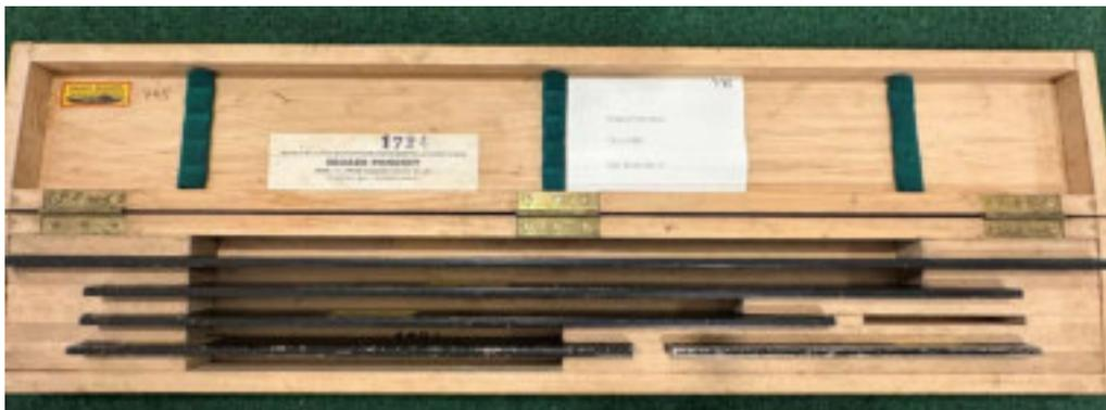
*Abbildung 218: Prüfstäbe zur Kluppeneichung in Holzkassette.*
