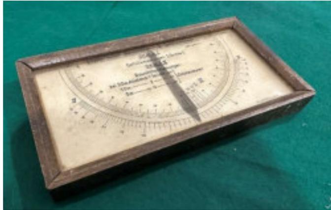
Abbildung 207: Doppler'sche Baumhöhen- und Gefällsmesser.
