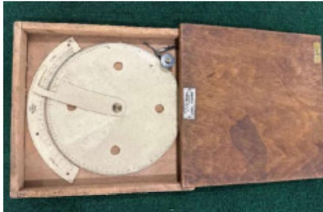
*Abbildung 162: Kreisrechenschieber nach Riebel.*
