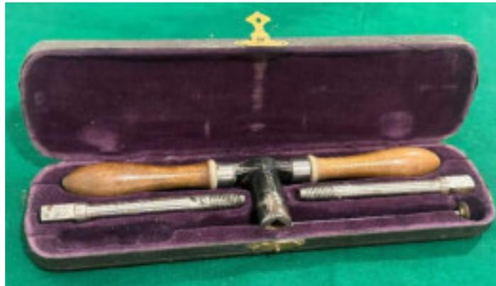
*Abbildung 272: Zuwachsbohrer.*
