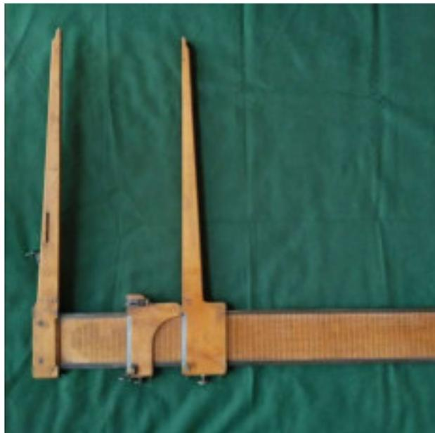
*Abbildung 622: Messkluppe mit integrierter Kubierungstabelle und Visiereinrichtung für die Baumhöhenmessung.*
