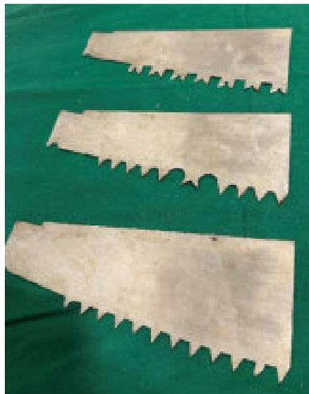
*Abbildung 374: 3 Modelle Zugsägen, verschiedene Zahnformen.*
