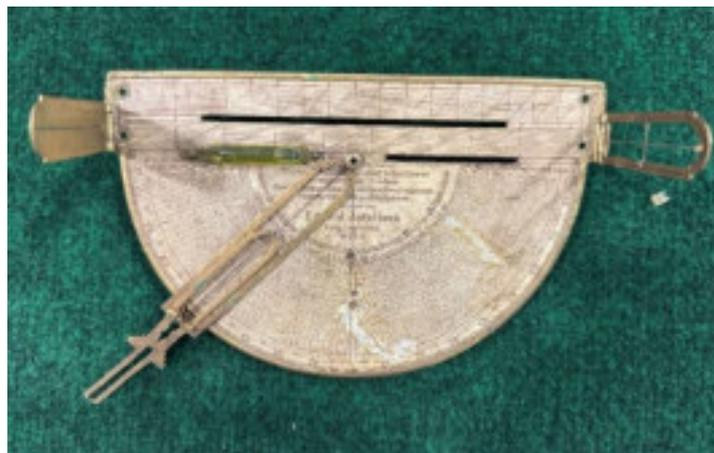
*Abbildung 138: Universalmessrechenschieber.*
