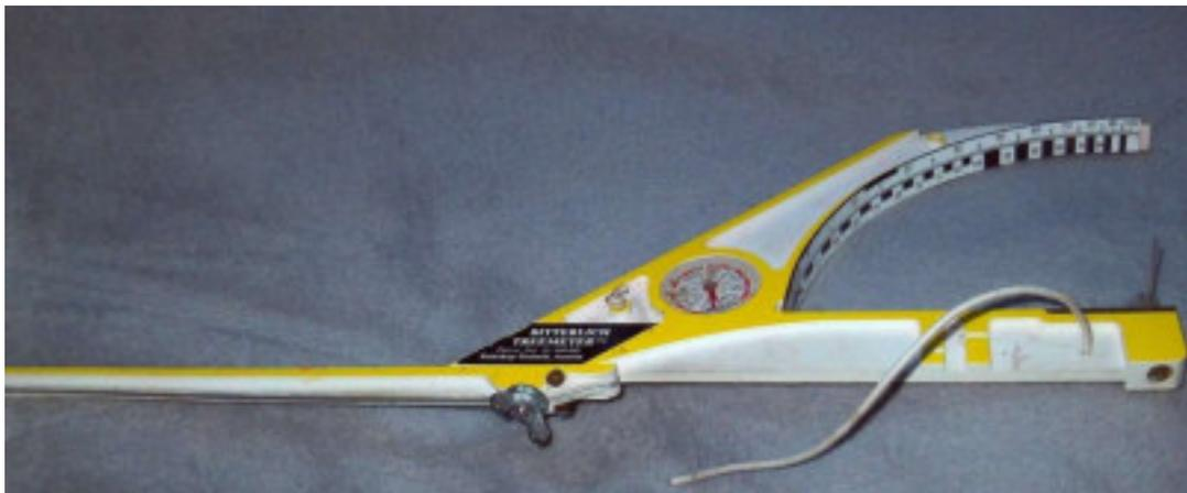
Abbildung 578: Sektormesskluppe, späte 1990iger Jahre der Firma Relaskop-Technik, Austria in Kunststoffausführung, Hand-schleife und Kompass.
