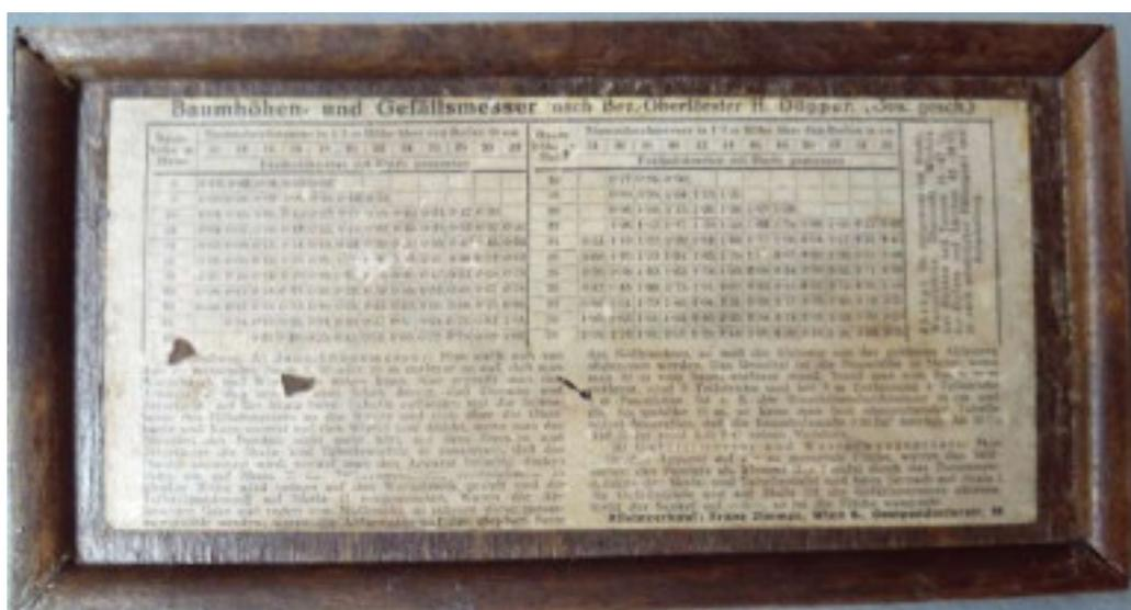
Abbildung 645: Döpfer`scher Baumhöhen - & Gefällsmesser, Geräterückseite mit Angabe der Holzmasse in Abhängigkeit von Stammdurchmesser und Baumhöhe.
