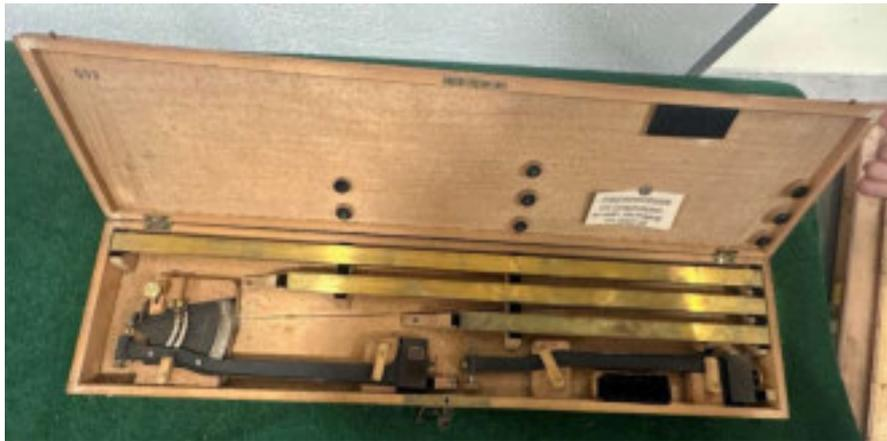
*Abbildung 236: Präzisionsmesskluppe und Zuwachsmesser mit el. Übertragung.*
