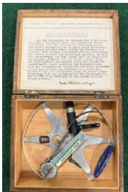
*Abbildung 438: Prototyp Relaskop Bitterlich.*
