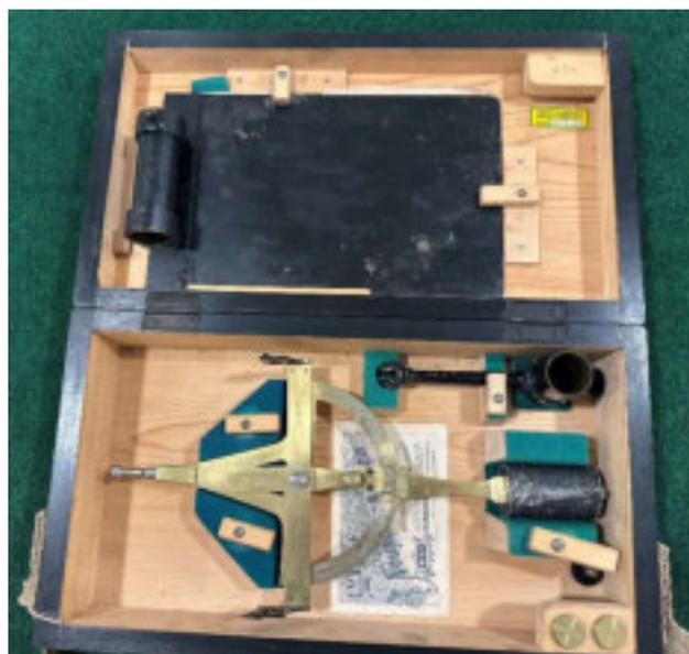
*Abbildung 145: Präzisions-Gefällsmesser "Neuhöfer".*
