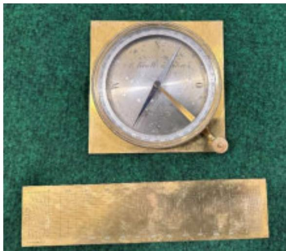
*Abbildung 139: Bussole Fa. Kraft und Sohn + Transversalmaßstab.*
