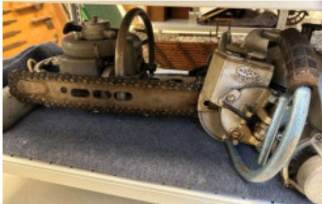
*Abbildung 35: Komet Motorsäge mit Pressluftantrieb.*
