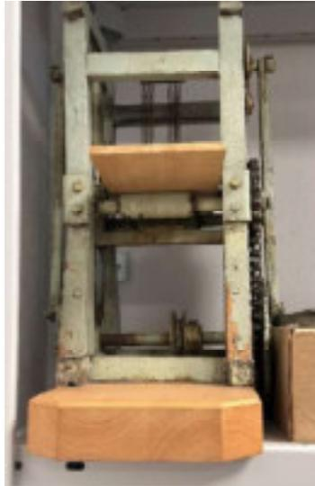
Abbildung 327: Modell einer Gattersäge aus dem Triestingtal.
