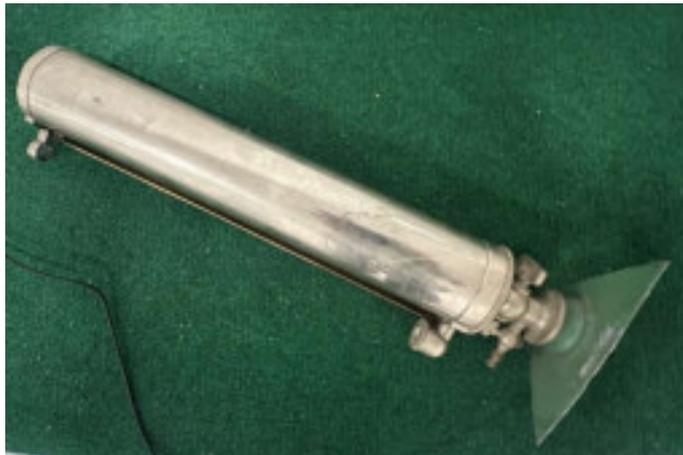
*Abbildung 223: Messgerät zur Erfassung der Niederschlagsmenge.*
