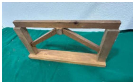
*Abbildung 341: Einfachsprengwerk.*
