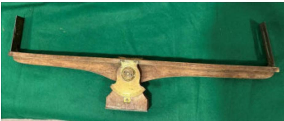
*Abbildung 179: Visureinrichtung für Messtisch.*
