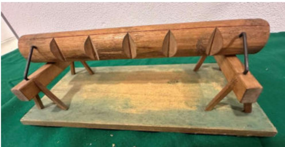
*Abbildung 356: Bauholzbearbeitung, Rundstamm auf Vierkantbalken.*
