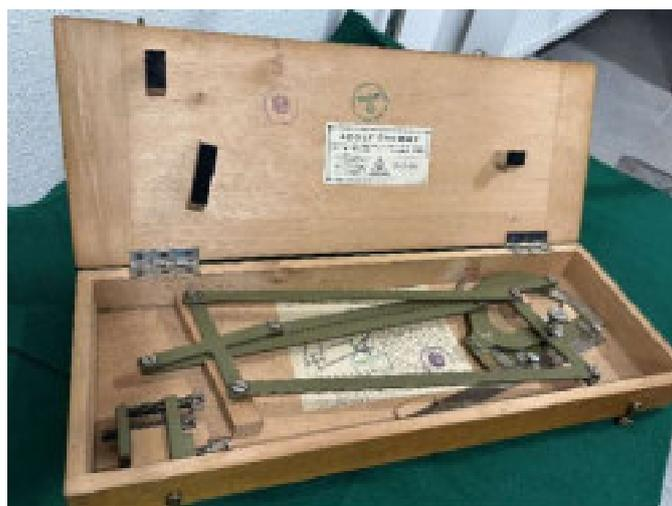
*Abbildung 278: Auftragegerät.*
