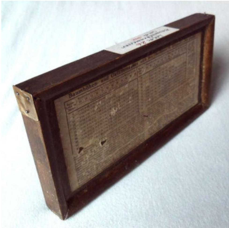
Abbildung 646: Visureinrichtung am Holzrahmen.
