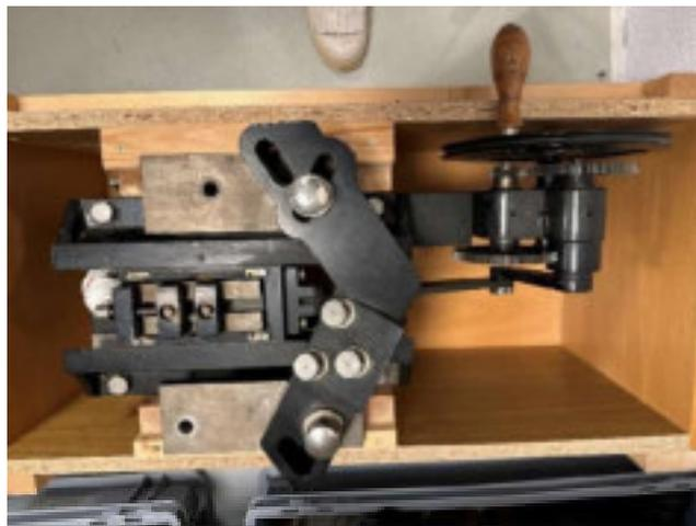
*Abbildung 394: Mikrotom: mechanisches Gerät zur Jahringmessung Erzeuger Reichert Wien.*
