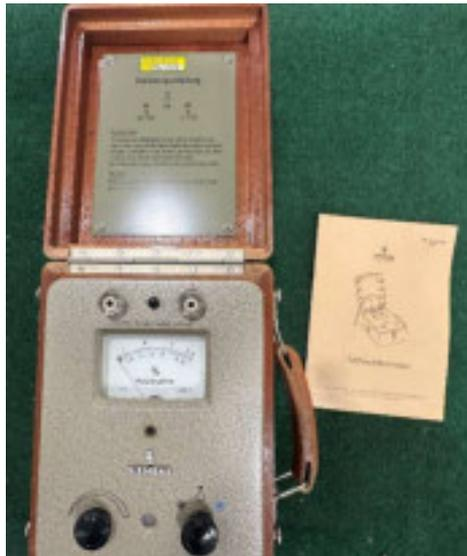
*Abbildung 220: Holzfeuchtemessgerät in Holzkassette.*
