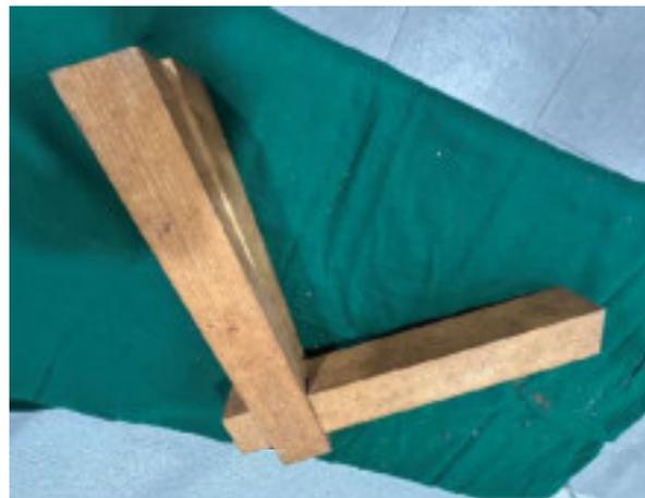
*Abbildung 337: Holzblockbau-Eckerverbindung.*
