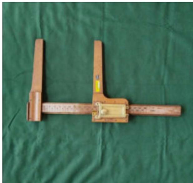
*Abbildung 623: Messkluppe mit Arretierungsvorrichtung.*
