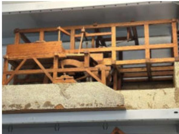
*Abbildung 334: Modell Sägewerk, Venetianergatter.*
