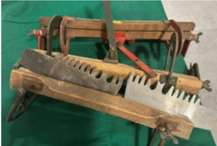
*Abbildung 373: 3 Einspannvorrichtungen zum Schärfen von Zugsägen.*
