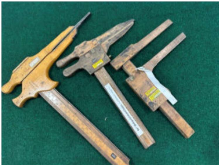
Abbildung 312: 3 Präzisionsholzmesskluppen aus Holz.
