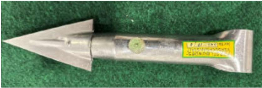
*Abbildung 165: N-Tester; Geiselheimer Wasserzange.*
