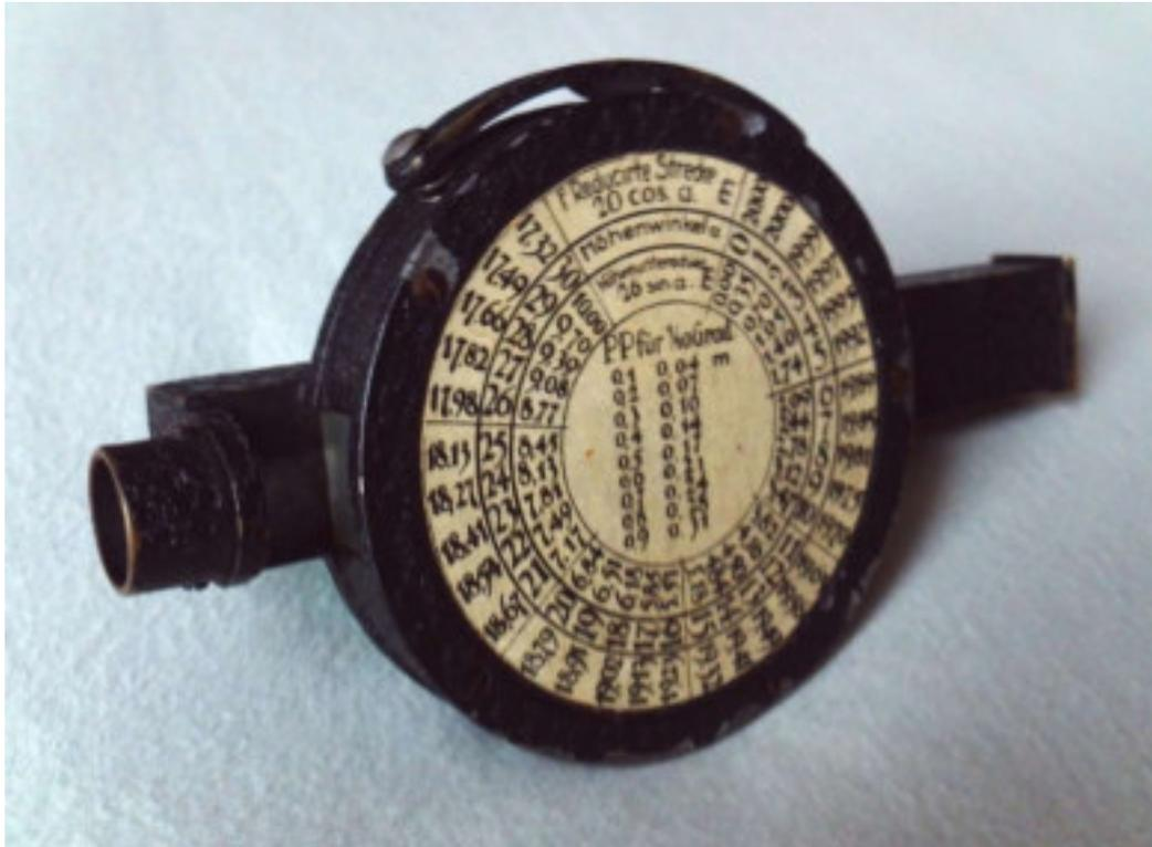
Abbildung 652: Gefälls- und Böschungsmesser nach Brandis.
