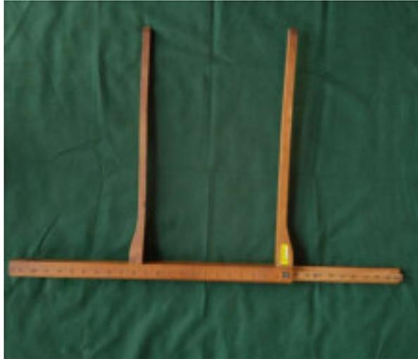
Abbildung 617: Holzmesskluppe mit ineinander schiebbarer Schiene.
