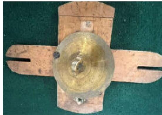
*Abbildung 244: 2 Grundplatten für Messinstrument; eines davon mit Möglichkeit zum Verdrehen.*
