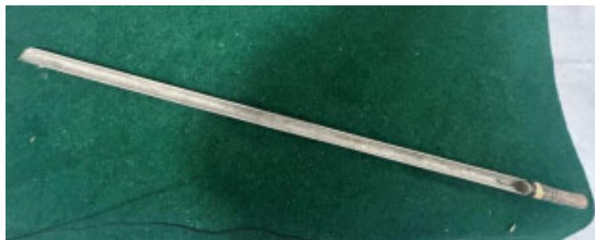
*Abbildung 62: Erdbohrer für Bodenproben.*
