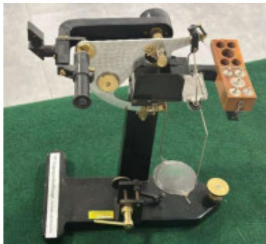
*Abbildung 175: Neigungsschnellwaage.*
