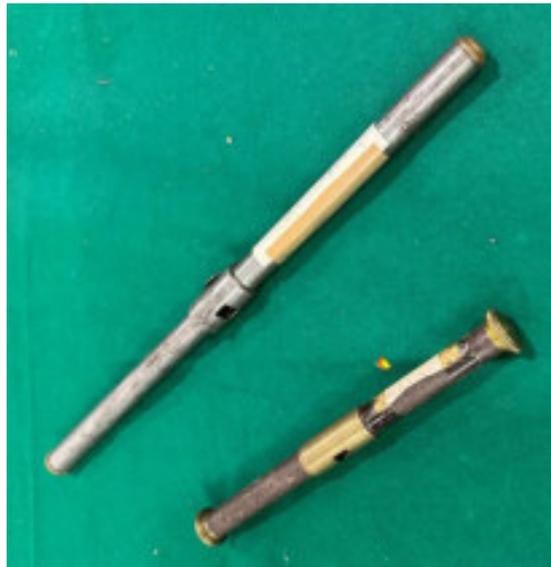
Abbildung 294: 2 Zuwachsbohrer beschädigt.
