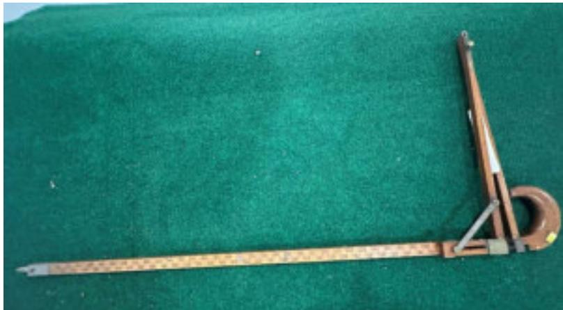
*Abbildung 319: Messstock mit Holzmesskluppe.*
