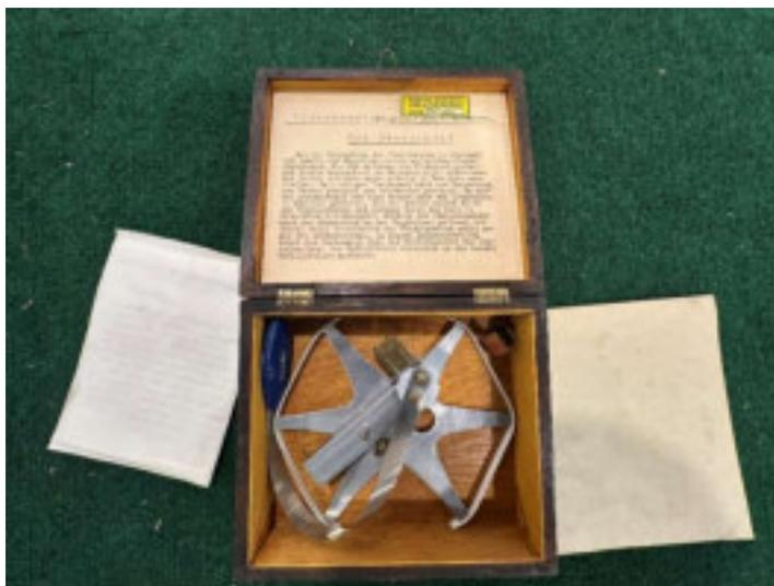
*Abbildung 442: Prototyp Relaskop Bitterlich.*
