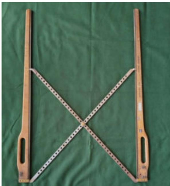
Abbildung 621: Messkluppe nach dem Scherenprinzip.
