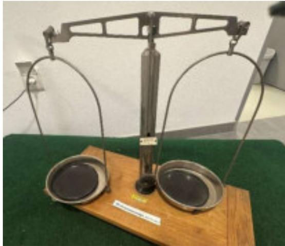
*Abbildung 227: Präzisionswaage nach Kroneis.*
