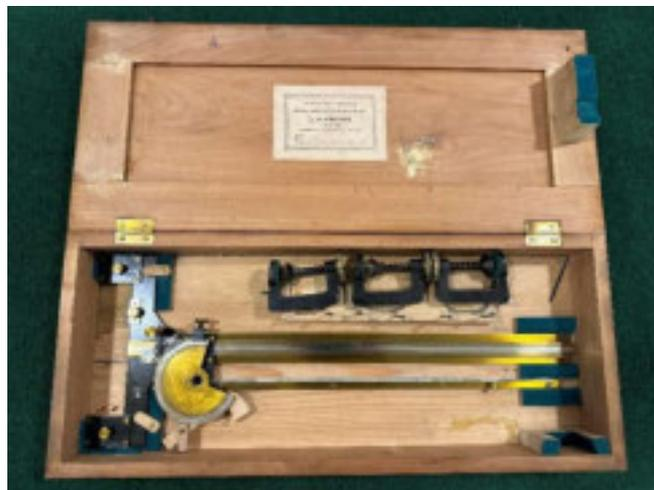
Abbildung 142: Tachygraph; Erzeuger: E. Schneider.
