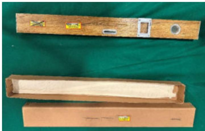
*Abbildung 184: Wasserwaage für Neigungsmessungen.*
