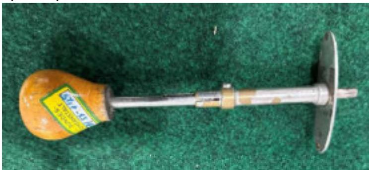
*Abbildung 157: Rindenstärkenmessgerät.*
