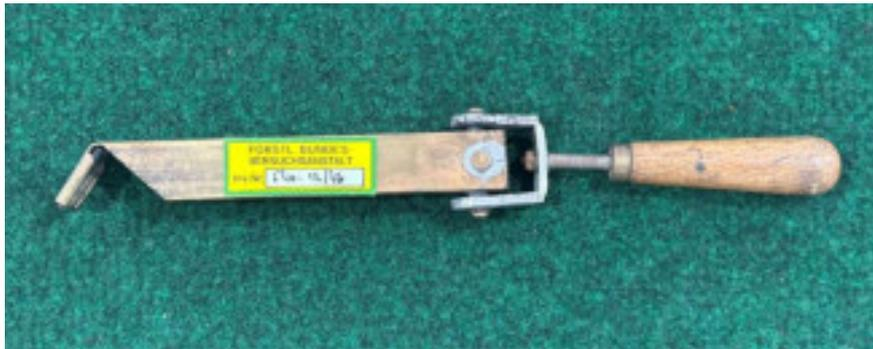
*Abbildung 117: Lötrohr mit Spiegel zur Messung Kronenprojektion.*
