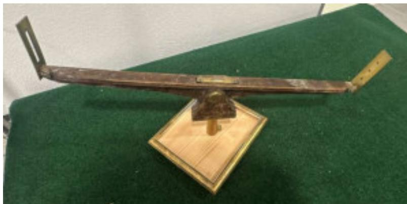
*Abbildung 305: Visureinrichtung Messtischaufnahme.*
