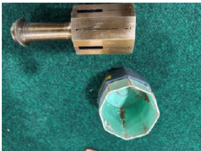
*Abbildung 164: Winkeltrommel aus Messing.*
