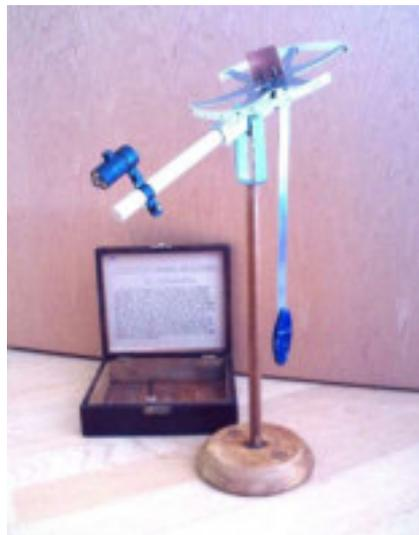
Abbildung 588: Das Pendelrelaskop zur Darstellung des Funktionsprinzips in Arbeitsposition (mit Lupe auf verkürztem Stab).
