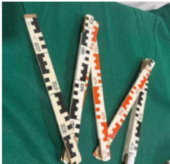
*Abbildung 268: klappbare Messlatte 3m.*
