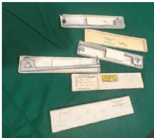
*Abbildung 104: 3 Stück Schneidenplanimeter Marke Geomat.*
