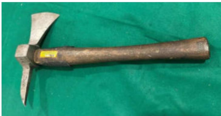
*Abbildung 98: Axt mit Sappelfunktion.*
