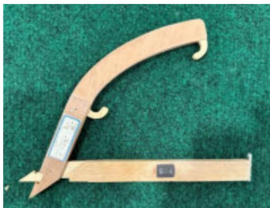
*Abbildung 154: Messwinkel; Messinstrument nach F. Hempel.*
