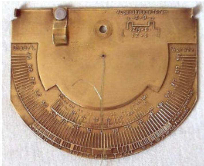
Abbildung 647: Neigungsmesser mit Pendel zur Ermittlung von Zuschlagswerten für die Winkelzählprobe.
