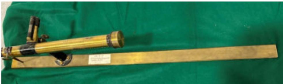
*Abbildung 178: Nivellierinstrument für Messtisch.*
