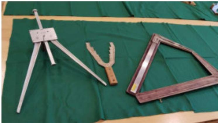
Abbildung 599: Baummesskluppen in Gabelform und Präzisionsmesskluppe.
