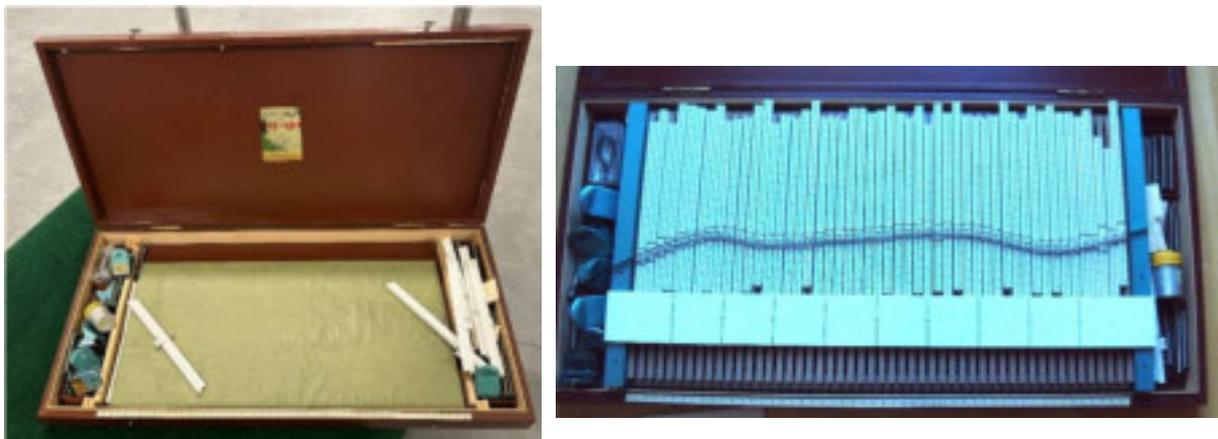
Abbildung 592: Biegelinienausgleichsinstrument.
