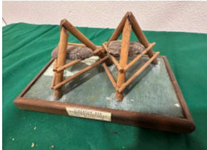
*Abbildung 357: Steinschlagsicherung, Rechenböcke.*
