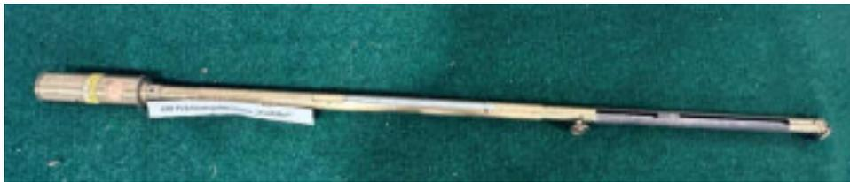
Abbildung 301: Präzisionsgefällmesser "Neuhöfer".
