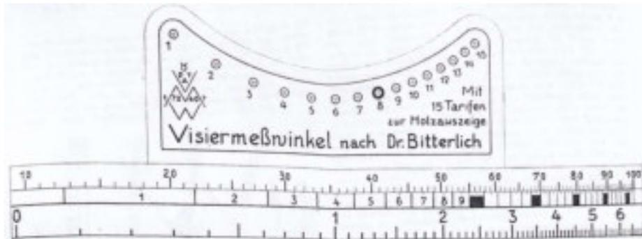
Abbildung 580: Skalen des Bitterlich'schen Tarifmesswinkels.
