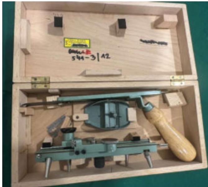
Abbildung 288: Jahringmessgerät.
