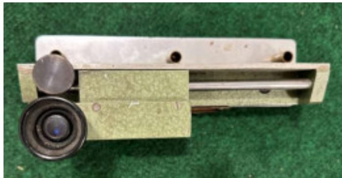
*Abbildung 169: Stammscheibenmessgerät nach Pollanschütz.*
