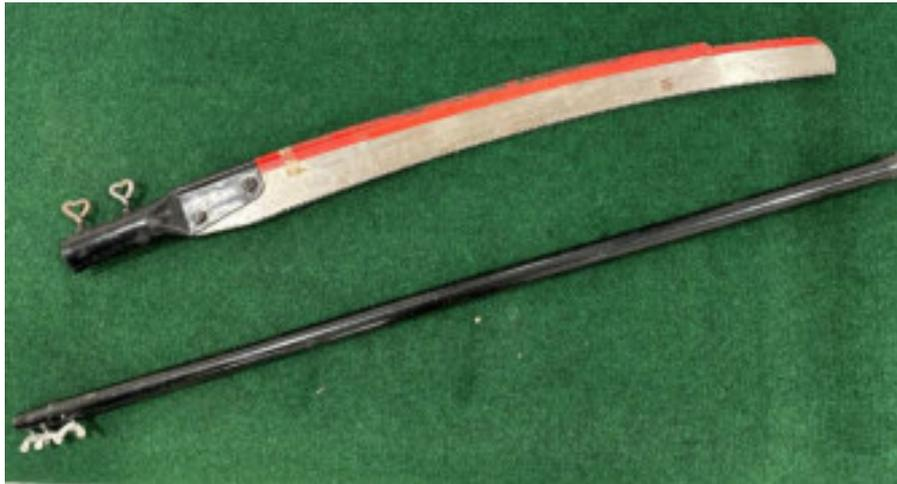
*Abbildung 23: Gestängesäge für Wertastung.*
