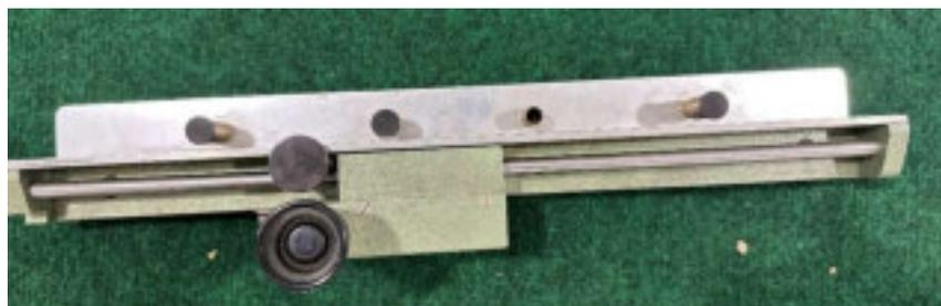
*Abbildung 158: Stammscheibenmessgerät.*
