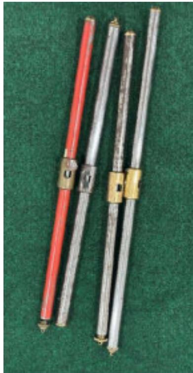
*Abbildung 116: 4 Zuwachsbohrer.*
