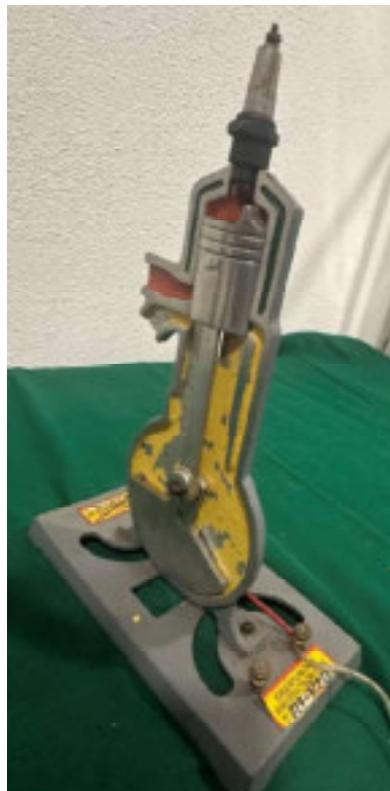
Abbildung 381: Modell Simulation Zündfunke 2 Takt-Motor.
