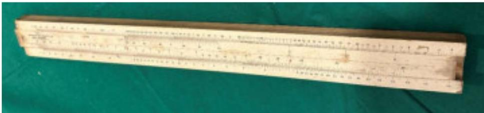
*Abbildung 277: Reduktionsrechenschieber.*
