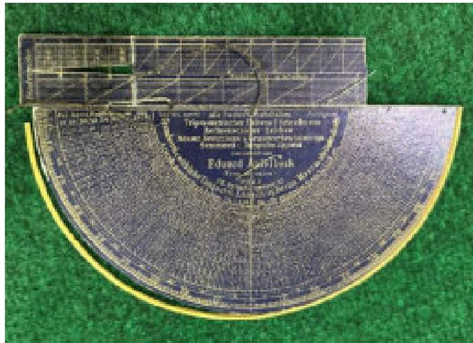
Abbildung 129: Schnellmessrechner.
