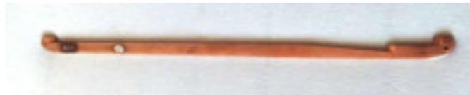
Abbildung 638: Baumhöhenmesser für die 1/10 Methode.
