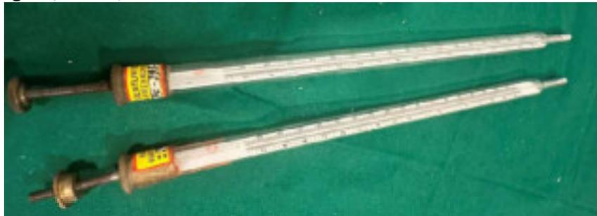
*Abbildung 103: 2 Stück Quecksilberthermometer.*
