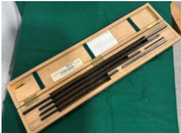
*Abbildung 280: Kluppenprüfstab in Holzkassette.*
