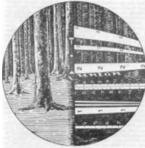
Abbildung 590: Modell der Pendeltrommel (links), Baumhöhenmessung mittels Spiegelrelaskop (rechts).
