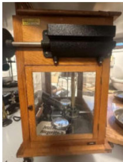
*Abbildung 228: Analysenschnellwaage.*
