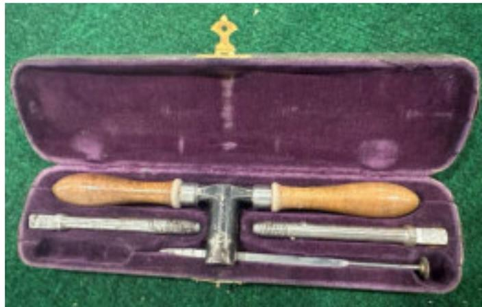
Abbildung 211: Zuwachsbohrer zerlegbar in Kasette.
