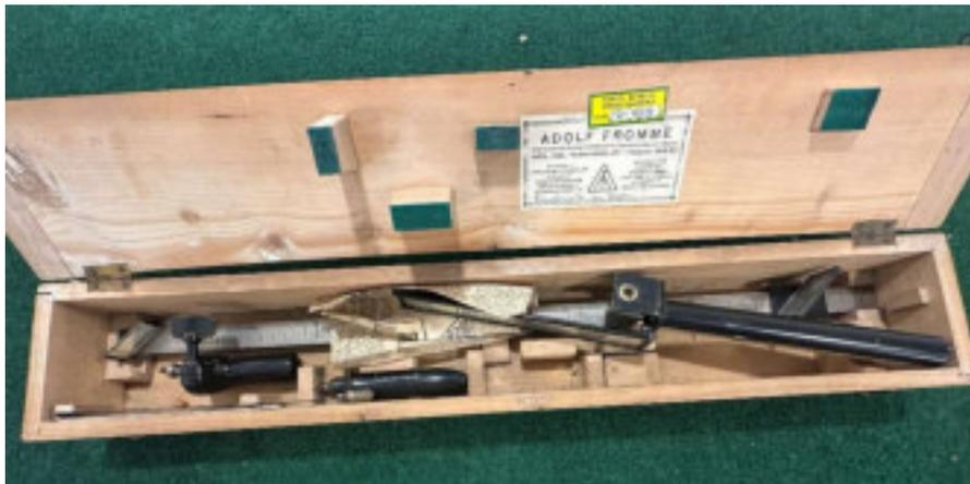
*Abbildung 217: Dendrometer in Holzkassette.*
