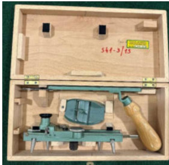
Abbildung 146: Bohrkernmesslupe nach Pollanschütz.
