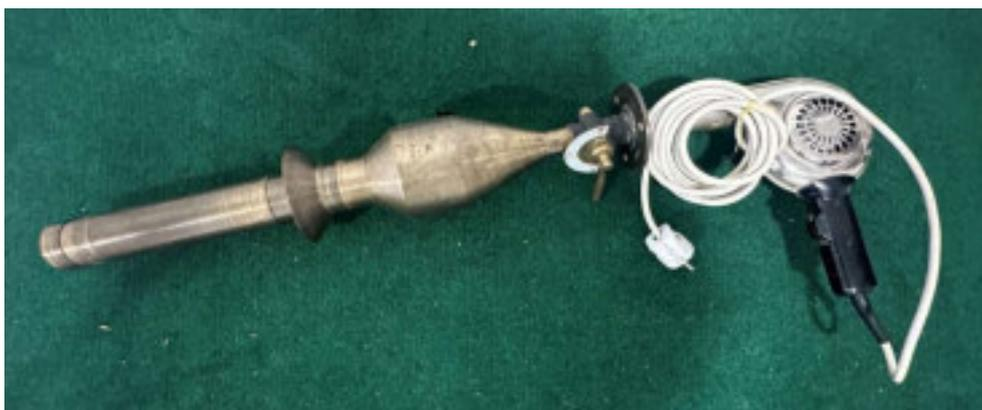
*Abbildung 59: Laborsteigsichter mit elektrischem Gebläse.*
