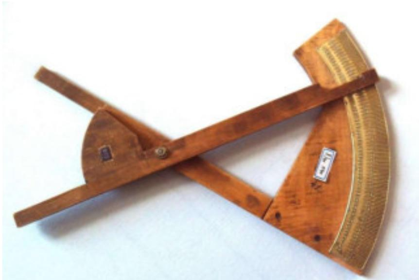
Abbildung 632: Messwinkel mit Prozentskala: z.B: Ablesewert 200 entspricht 63,4 Grad.
