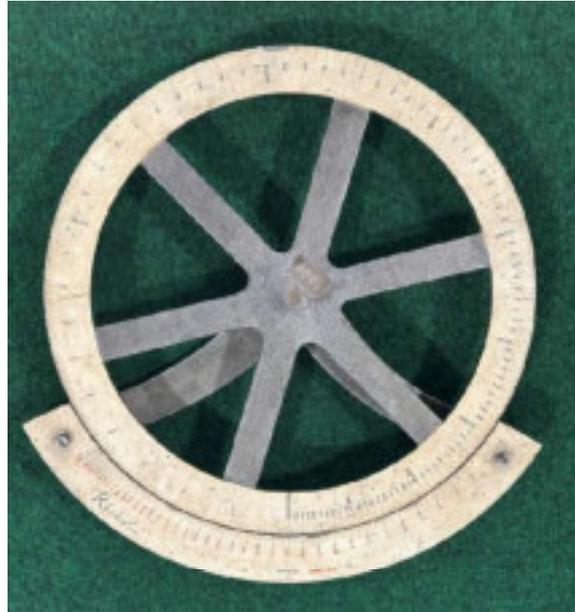
*Abbildung 115: Kreisrechenschieber nach Riebel.*
