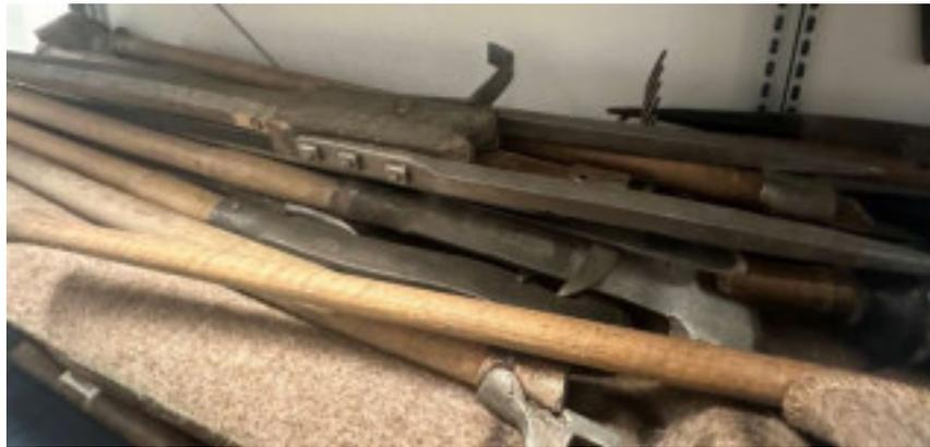
*Abbildung 66: Konvolut Hohlbohrer, Loheisen, Griesbeil, etc.*
