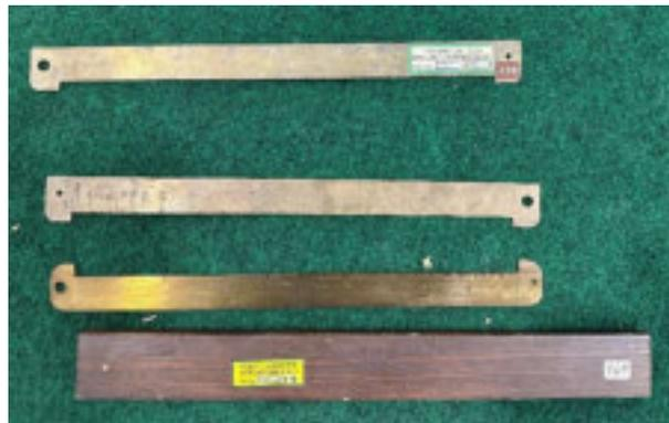
*Abbildung 153: Baumhöhenmessstäbe 3 Stück dav. 2 in Holzkassette.*
