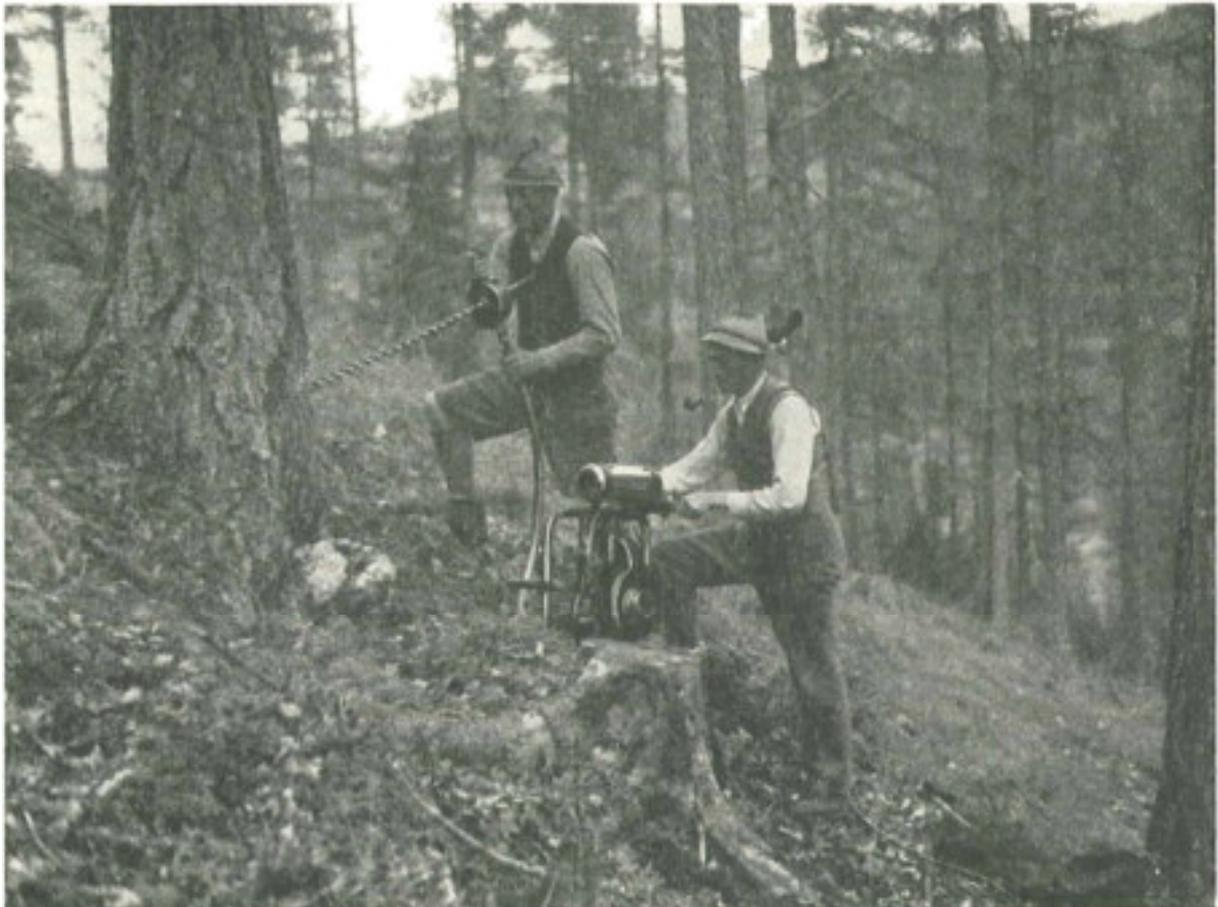
Abbildung 535: Der Bohrwinkel wird an Handhaben mit beiden Händen gehalten und mit ihm die Richtung des Bohrers dirigiert, der mittels Brustplatte vorwärts gedrückt wird. Dazu eignen sich am besten Schlangen- oder Schraubenbohrer.
