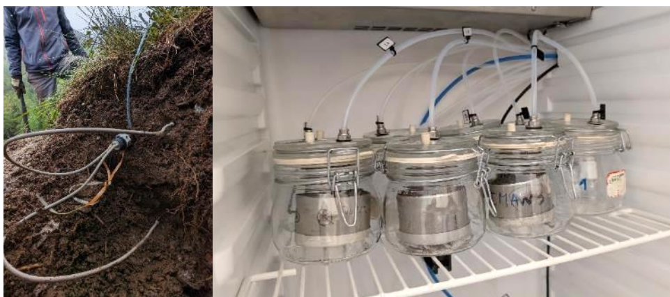
Abbildung 5: (links) Sensoren zur Messung der Bodentemperatur im Feld (10 cm und 20 cm Tiefe). (rechts) Inkubationsanlage zur automatischen Messung der CO 2 Freisetzung im Labor.
