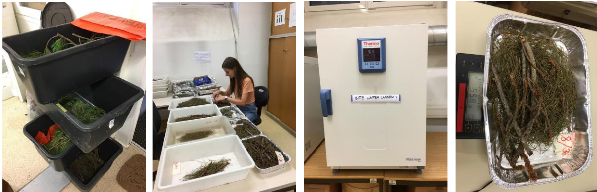
Abbildung 4: Laborarbeiten zur Entwicklung von Biomassefunktionen für Zirbe. Vortrocknung der Proben, Probenvorbereitung, Trocknung im Trockenschrank bei 103° C, Kontrolle auf Gewichtskonstanz (von links)
