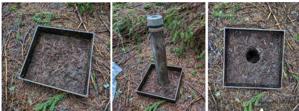
Abbildung 3: Von links nach rechts: Humusrahmen mit bereits daraus gesampelter Humusschicht, Einschlagbohrer für Wurzelproben. 10cm tiefes Loch aus der Wurzelprobennahme. Die Wurzelprobe für die 10-20 cm Bodenschicht wurde anschließend an derselben Stelle durch weiteres Einschlagen gewonnen.
