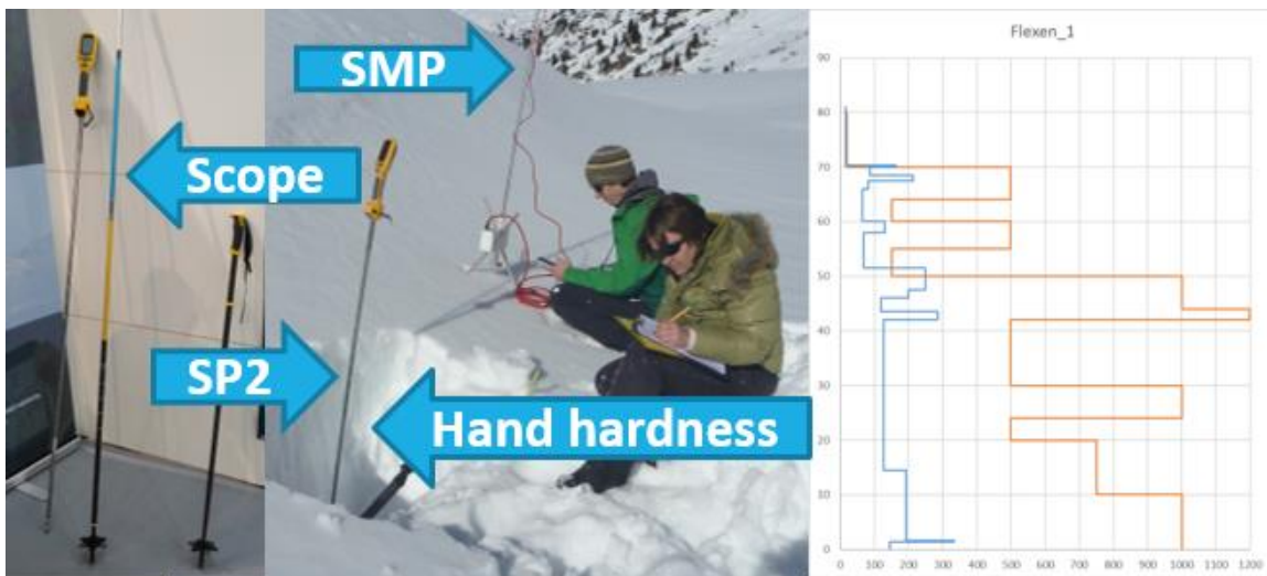
Abbildung 9 Sonden im Vergleich. Rechts die Gegenüberstellung eines Handhärteprofil mit einer Scope-Messung
