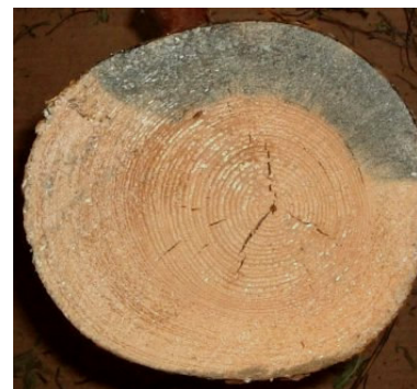
Stammquerschnitt mit blauem Splintholz – Befall durch Sphaeropsis sapinea
