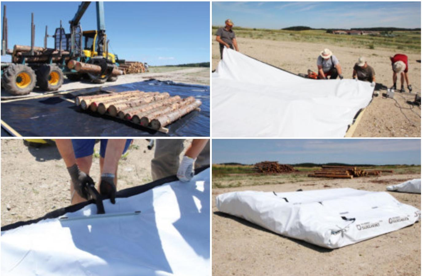
**ABBILDUNG 1:** Aufbau der Versuchspolter und Verpackung in Silofolie: Auf Unterlagshölzern werden die käferbefallenen Blöcke vorsichtig auf der ausgebreiteten Silofolie platziert. Die Folie wird mittels Impulsschweißzange luftdicht verschweißt, das Paket mit Hilfe von Klebeband möglichst kompakt und windstabil gemacht.
