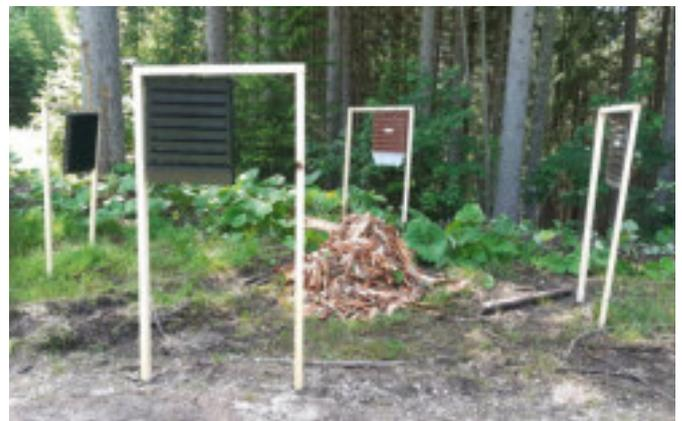
**ABBILDUNG 2:** Versuchseinheit mit Rindenhaufen im Zentrum und vier unbeköderten Käferfallen.
