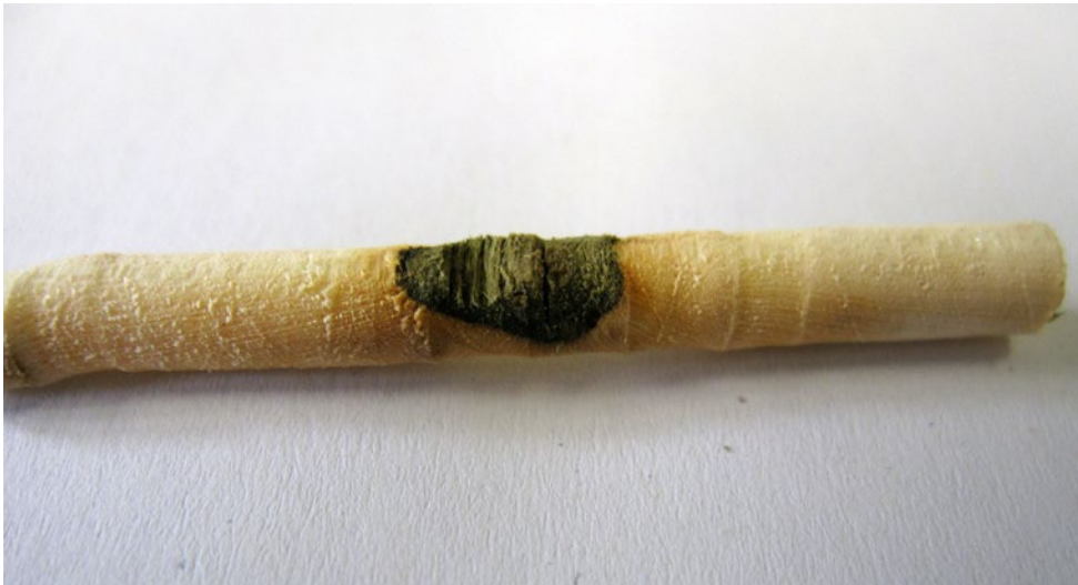
Abbildung 3: Bohrkern-Probe mit Verfärbung von einem Standort bei Würzburg.
