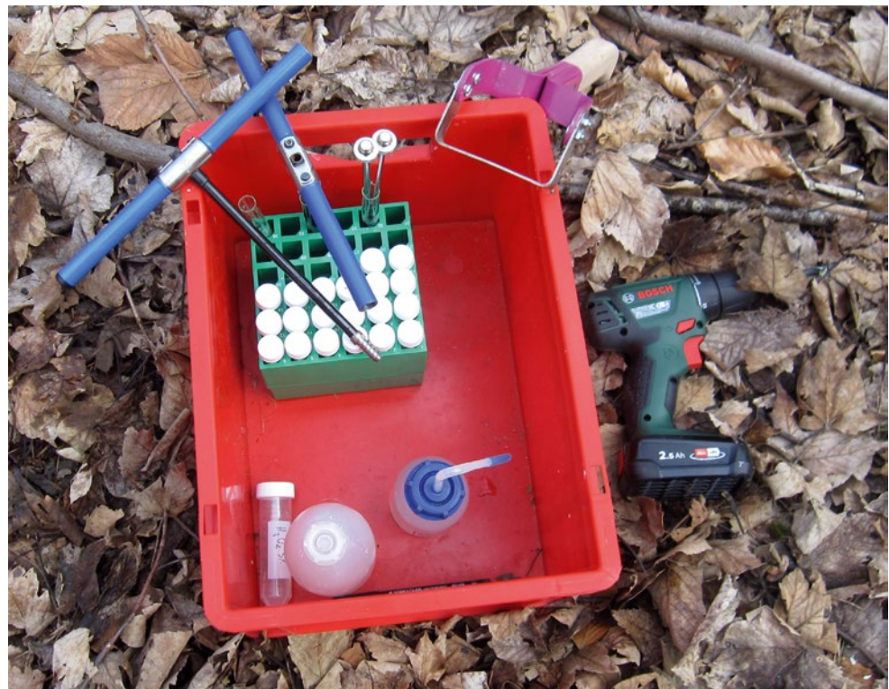
Abbildung 2: Material zur Probenahme und Reinigung: Bohrmaschine zum Vorbohren, Reagenzgläser mit Wasserstoffperoxid zur Reinigung der Utensilien, Spritzflasche mit Wasser zum Nachspülen, Schabeisen zum Entfernen der äußeren Rinde und Gefäße zur Probenahme.
