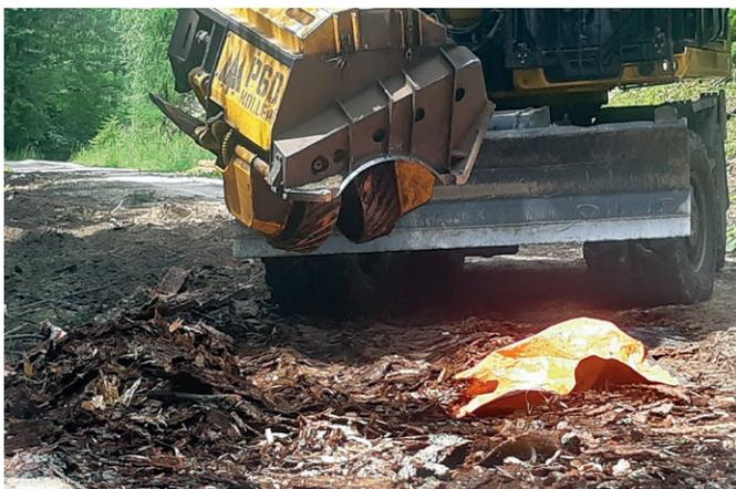
**ABBILDUNG 5:** Nach mehrmaligem Überfahren mit dem Harvester stark verdichteter Rindenhaufen.
