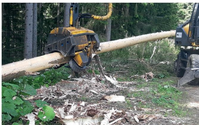
**ABBILDUNG 1:** Entrindung der Fichtenstämme mittels eines umgerüsteten Harvesteraggregats.
